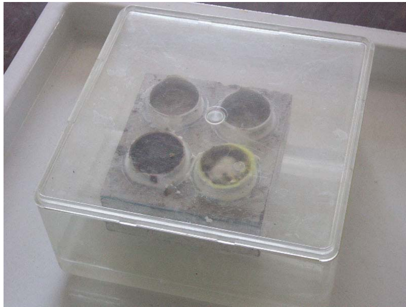
Bild 14: Probe in Plastik-Box über Wasser gelagert
